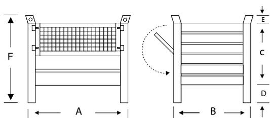
Portata 1000 kg con anta in rete elettrosaldata
